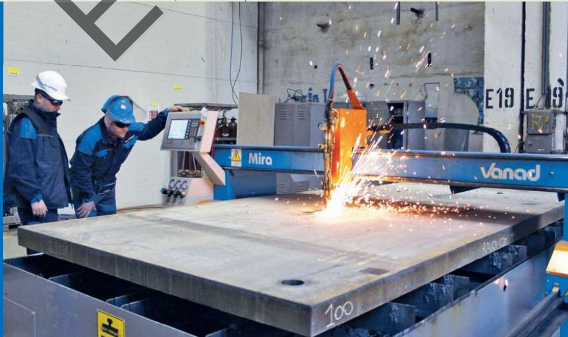
◀ CNC pálicí stroj Vanad MIRA je vybaven autogenní technologií, laserovým ukazovátkem a elektrickým zapalováním plamene autogenního hořáku. Snímek zachycuje propal 100 mm konstrukční oceli. CNC stroj MIRA je také nainstalován v našem předváděcím centru, kde si jej můžete prohlédnout a vyzkoušet
