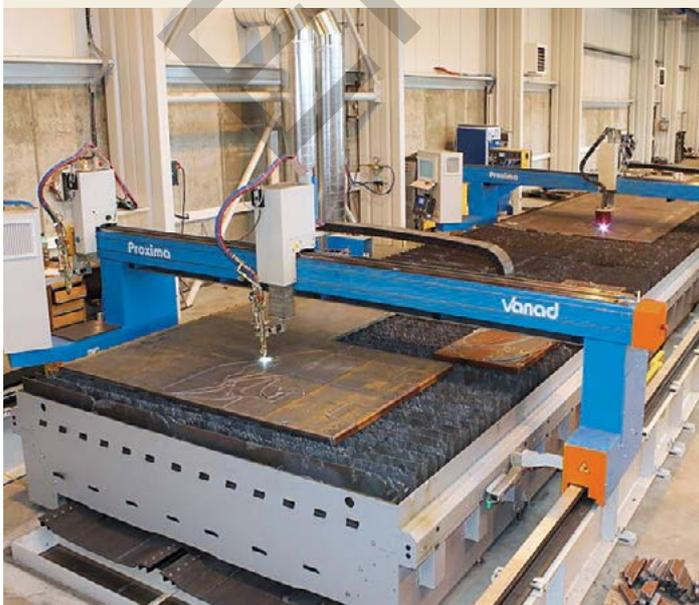
► Der halbautomatische Dreibrenner-Schneidkopf ist eine Zusatzanlage, die zum Fasenschneiden bestimmt ist. Die Fasenschnitte dienen oft als Schweißflächen
