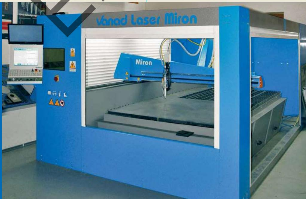
CNC pálicí stroj Vanad MIRON je špičkové zařízení s jednoduchou konstrukcí. Jeho výhodou je rychlá a jednoduchá montáž. Díky otevřenému přístupu může i přes malé rozměry zpracovávat větší nebo nestandardní formáty. Toto zařízení lze osadit třemi technologiemi: plazmou, autogenem a také laserem. Základní dodávané modely jsou MIRON s plazmovou nebo autogenní technologií, MIRON RotCUT pro řezání trubek a profilů a MIRON Laser.
