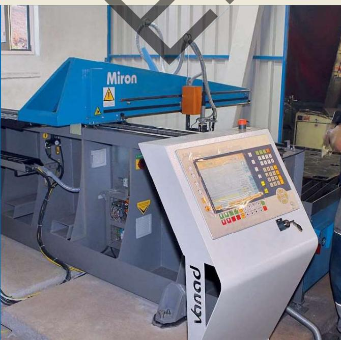
Vanad MIRON lze dodat jako kompletní pálicí pracoviště včetně plazmového, autogenního nebo laserového zdroje a spotřebních dílů, kompresoru pro dodávku vzduchu včetně jeho ošetření, odsávacího a filtračního zařízení pro odsávání zplodin vznikajících při termickém dělení
